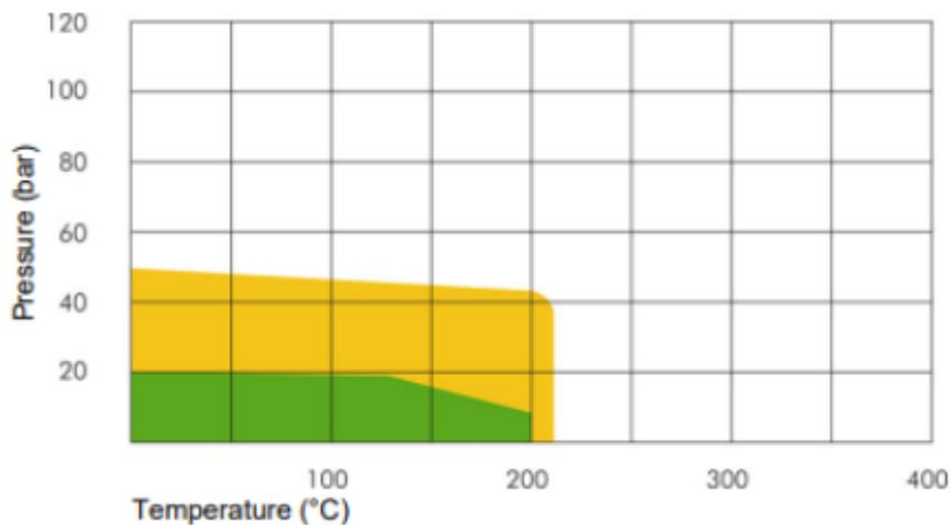
\*D/T-Abhängigkeit: Wenn das Material druck- und temperaturabhängig ist, dürfen der max. Druck und die max. Temperatur nicht gleichzeitig auftreten.
