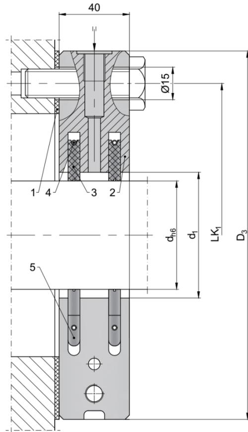
1: Flachdichtung, 2: Gehäuse (2-teilig), 3: Dichtring, 4: Zugfeder, 5: Arretierung
